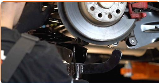
**21** Apriete las sujeciones que conectan el brazo de control a la mangueta trasera. Usa una llave mixta del n.º 18. Use un vaso de impacto del n.º 18. Utilice una llave dinamométrica. Apriételo a un par de 90 Nm.+90°
