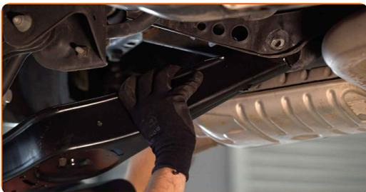
**18** Instale las sujeciones del brazo de control.
