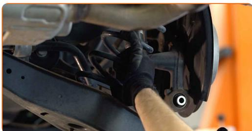
**15** Retire el perno de sujeción.
