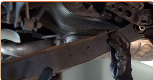
**17** Instale la nueva palanca de suspensión.
