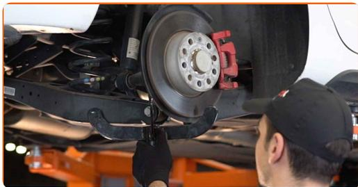
**12** Retire el perno de sujeción.
