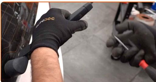
**5** Presione el clip de fijación. Utilice un destornillador plano. Retire la escobilla del brazo del limpiaparabrisas.
