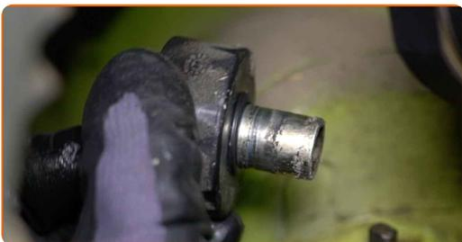
**22** Retire el perno de sujeción.
