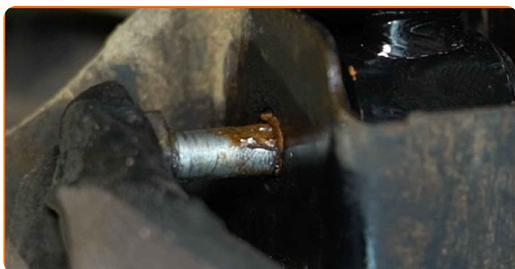
**29** Atornille la sujecion inferior del amortiguador. Usa una llave mixta del n.º 16. Use un vaso de impacto del n.º 16. Utilice una llave de trinquete.
