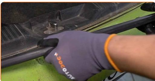
**4** Desenrosque las sujeciones del panel del umbral del maletero.
