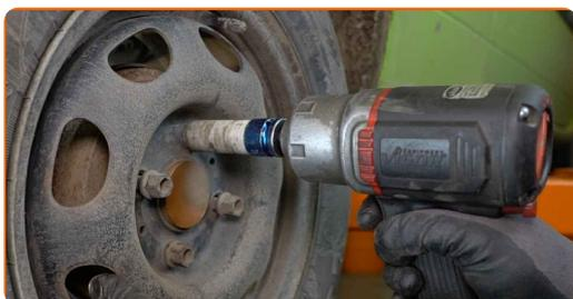
**39** Baje el automóvil y, manteniendo el orden cruzado, apriete los pernos de fijación de las ruedas. Utilice una llave de impacto para llanta # 17. Utilice una llave dinamométrica. Apriételo a un par de 110 Nm.
