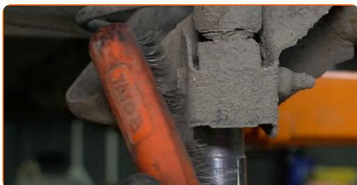
**19** Destornille la fijación inferior del amortiguador. Usa una llave mixta del n.º 16. Use un vaso de impacto del n.º 16. Utilice una llave de trinquete.
