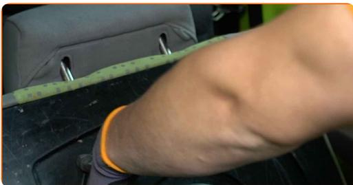
**8** Separe el revestimiento de la parte lateral del maletero.
