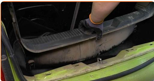
**6** Desenrosque las sujeciones del panel lateral del maletero. Utilice Torx T25.
