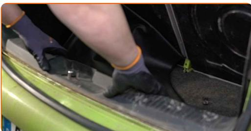
**48** Enrosque las sujeciones del panel del umbral del maletero.
