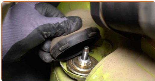
**10** Limpie las sujeciones del amortiguador. Use un cepillo de alambre. Use el aerosol WD-40.
