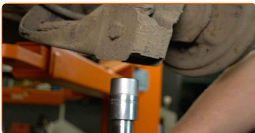
**18** Limpie las sujeciones del amortiguador. Use un cepillo de alambre. Use el aerosol WD-40.
