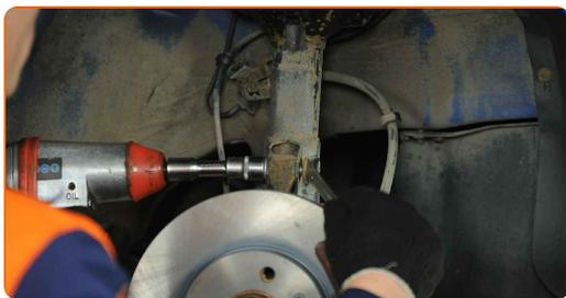
**10** Desconecte el muñón de dirección de la pata amortiguadora.
