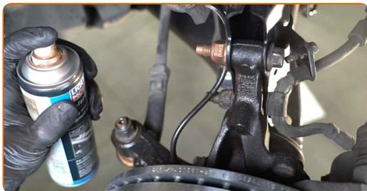
**39** Trate la superficie donde el disco del freno entra en contacto con la llanta de la rueda. Use grasa de cobre.
