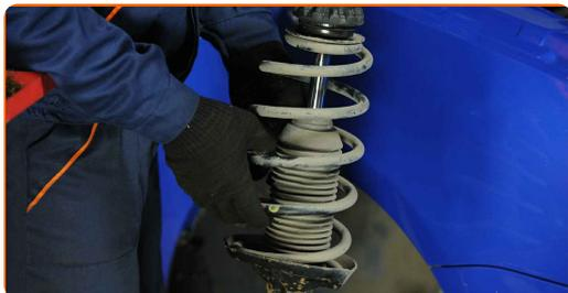
28 Atornillen la fijación superior de la cazoleta de la pata amortiguadora.
