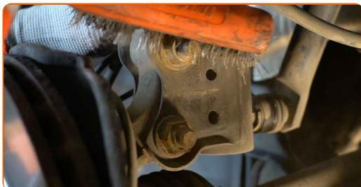
**9** Desatornille la sujeción inferior que conecta el puntal amortiguador a la mangueta de dirección. Usa una llave mixta del n.º 18. Use un vaso de impacto del n.º 18. Utilice una llave de trinquete.
