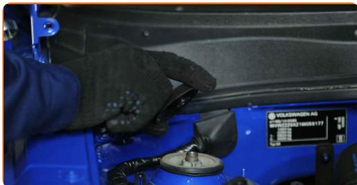
**15** Destornille la fijación superior de la cazoleta de la pata amortiguadora. Usa una llave mixta del n.º 21. Use Vaso HEX No. H7. Utilice una llave de trinquete.
