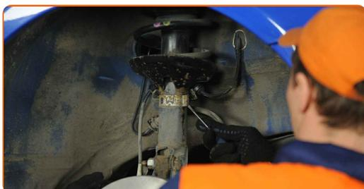
**7** Desconecte el cableado del captador ABS.
