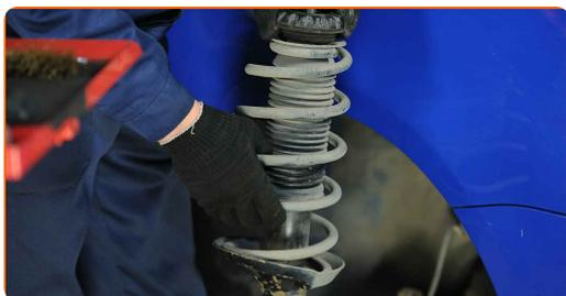
**17** Instale la pata amortiguadora en el mecanismo para apretar los resortes.
