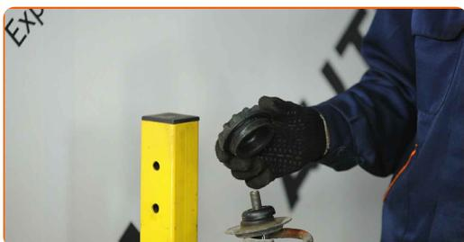
**24** Apriete la tuerca de la varilla de la pata amortiguadora. Use un vaso de impacto del n.º 21. Use Vaso HEX No. H7. Utilice una llave dinamométrica. Apriételo a un par de 60 Nm.
