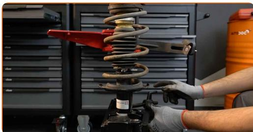
27 Instale la pata amortiguadora en el arco de la rueda.
