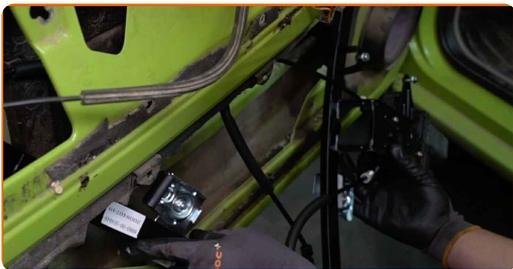
**25** Atornille las sujeciones del mecanismo regulador de ventanillas. Use un vaso de impacto del n.º 10. Utilice una llave de trinquete.
