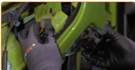
**17** Desenrosque las sujeciones del ensamblaje del regulador de ventana. Use un vaso de impacto del n.º 10. Utilice una llave de trinquete.
