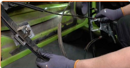
**20** Desenrosque las sujeciones del elevavinas eléctrico. Utilice un destornillador Phillips.
