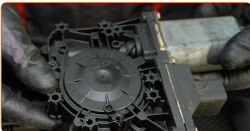
**22** Instale y enrosque las sujeciones del motor en el nuevo mecanismo regulador de ventanillas. Utilice un destornillador Phillips.
