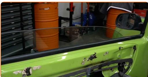
**13** Desenrosque las sujeciones del cristal de la ventana. Use un vaso de impacto del n.º 10. Utilice una llave de trinquete.
