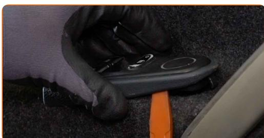
**5** Separe los conectores del elevavinas de la unidad de control.
