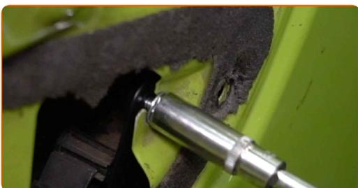
**26** Una el conector al motor del elevalunas eléctrico.
