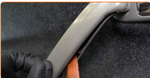
**7** Desenrosque la sujeción de la manija de la puerta. Utilice un destornillador Phillips.
