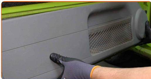
**42** Enrosque las sujeciones del panel inferior de la puerta. Utilice un destornillador Phillips.
