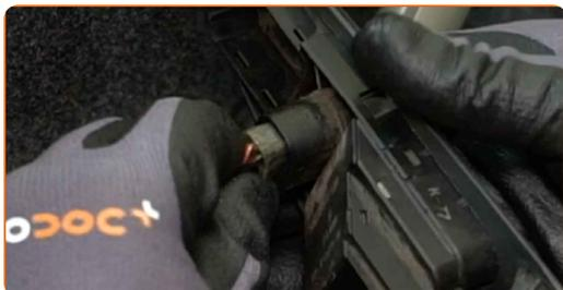
**40** Instale el módulo del interruptor del elevavinas eléctrico.
