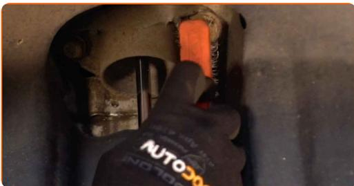
**7** Destornille la fijación inferior del amortiguador. Usa una llave mixta del n.º 16. Use un vaso de impacto del n.º 16. Utilice una llave de trinquete.
