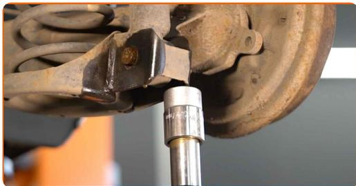
**9** Retire el perno de sujeción.
