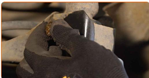
**10** Retire el soporte por debajo de la viga trasera.
