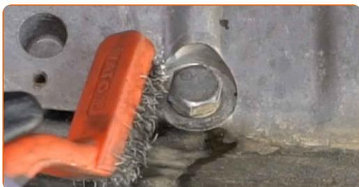
**12** Destornille el tapón de desagüe. Use un vaso de impacto del n.º 19. Utilice una llave de trinquete.
