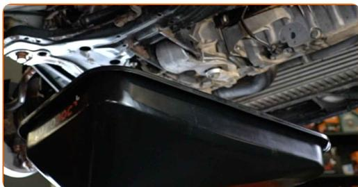
**11** Limpie el área del orificio de drenaje de la bandeja de aceite. Use un cepillo de alambre. Utilice un spray de limpieza multiuso.
