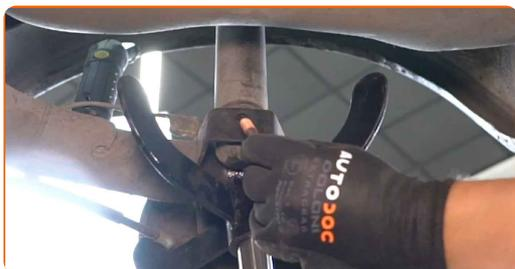
**21** Atornille la sujeción inferior del puntal de suspensión. Use una llave mixta del n.º 17. Use un vaso de impacto del n.º 17. Utilice una llave giramachos.
