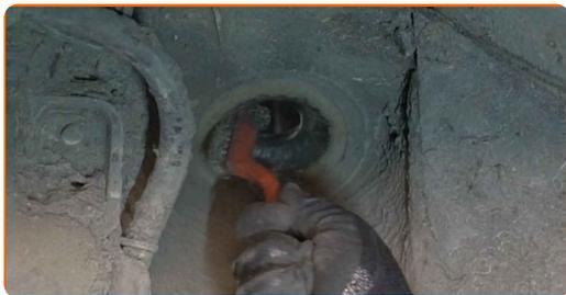
**17** Instale el soporte superior nuevo de la pata amortiguadora.
