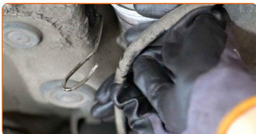
**7** Afloje las sujeciones del filtro de combustible. Use un vaso de impacto del n.º 7. Utilice una llave de trinquete.
