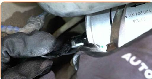
**14** Atornille el soporte de montaje del filtro de combustible. Use un vaso de impacto del n.º 7. Utilice una llave de trinquete.
