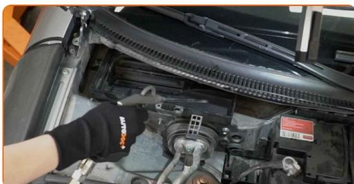
**9** Inserte en la carcasa del filtro el nuevo elemento filtrante. Asegúrese de que el borde del filtro encaje firmemente en la carcasa.
