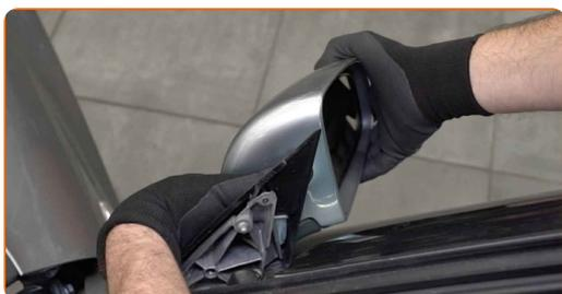
**27** Desenrosque las sujeciones del marco de la puerta del coche. Utilice Torx T45. Utilice una llave de trinquete.
