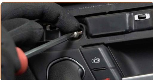
**9** Desenrosque las sujeciones inferiores de la placa de la puerta. Utilice un destornillador Phillips.
