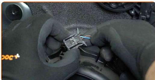
**13** Separe los conectores del elevavinas de la unidad de control. Utilice una herramienta de recorte de plástico.
