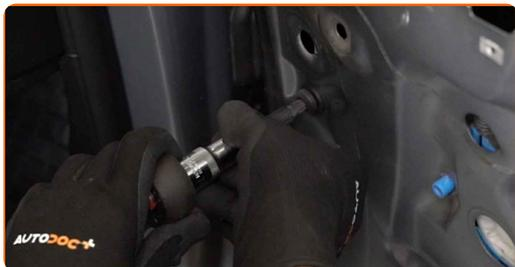
**28** Retire la tapa de las sujeciones del marco de la puerta. Utilice una herramienta de recorte de plástico.
