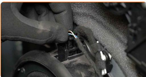
**65** Una el cable del actuador de la cerradura de la puerta.
