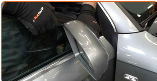
**46** Atornille la sujeción del espejo lateral. Utilice Torx T30. Utilice una llave de trinquete.
