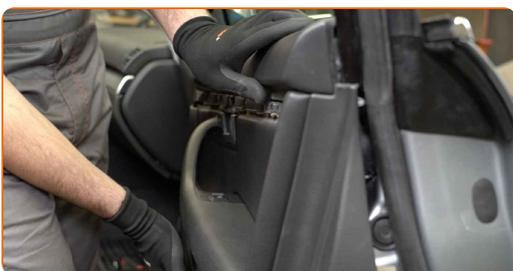
**67** Atornille las sujeciones superiores de la placa de la puerta. Utilice un destornillador Phillips.
