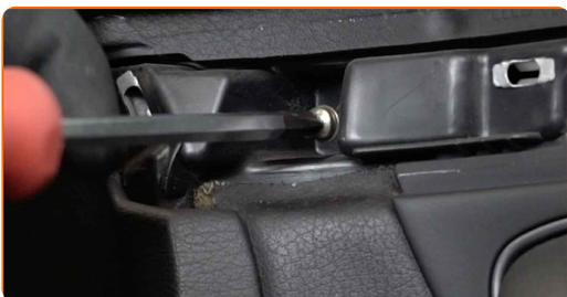
**8** Retire el tornillo de la manija de la puerta. Utilice un destornillador Phillips.
