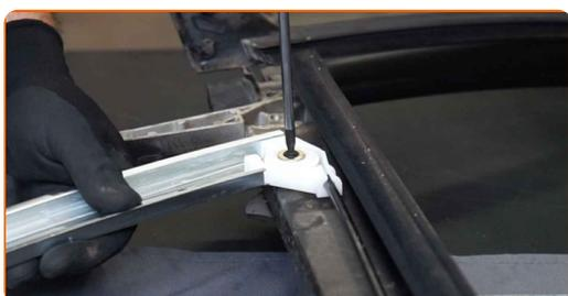
**39** Vuelva a instalar el cristal en el accionamiento del regulador de la ventana.
