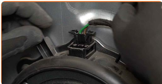
**20** Desatornille las sujeciones de los altavoces. Utilice Torx T25. Utilice una llave de trinquete.
