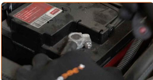
**4** Retire los terminales de la batería.
