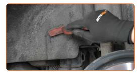
Desatornille y retire las sujeciones de la cubierta del paso de rueda. Utilice Torx T25. Utilice una llave de trinquete.
