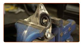
Apriete la tuerca de la varilla del amortiguador. Utilice un vaso para amortiguador DD№6. Use un vaso de impacto del n.º 18. Utilice una llave dinamométrica. Apriételo a un par de 35 Nm.
