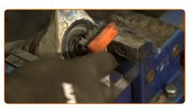
Destornille la fijación de la varilla del amortiguador. Utilice un vaso para amortiguador DD№6. Use un vaso de impacto del n.º 16. Utilice una llave de trinquete.
