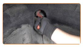
Coloque el amortiguador en el arco de la rueda y fíjelo.
