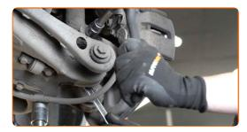
Retire el perno de sujeción.
