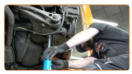
Apriete la fijación inferior del amortiguador. Usa una llave mixta del n.º 21. Use un vaso de impacto del n.º 21. Utilice una llave dinamométrica. Apriételo a un par de 150 Nm.+90°
