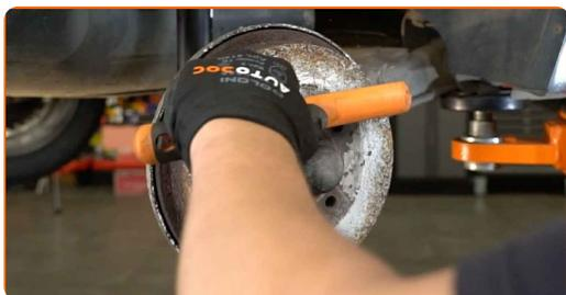
**34** Trate la superficie en la cual la llanta de la rueda entra en contacto con el tambor del freno. Use grasa de cobre.
