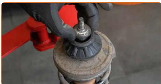
Sustitución: copelas del amortiguador - SEAT Ibiza II (6K1). AUTODOC recomienda:
