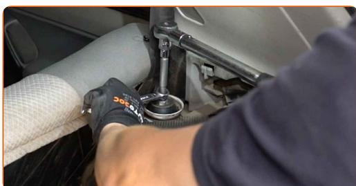
**40** Trate las sujeciones del soporte del amortiguador. Use grasa de cobre.
