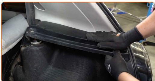
**42** Atornille las sujeciones del panel de plástico del revestimiento lateral. Use un vaso de impacto del n.º 10. Utilice una llave de trinquete.
