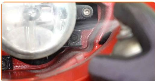
5 Desenrosque las sujeciones del faro antiniebla. Utilice Torx T20.
