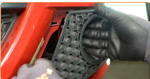
4 Trate las sujeciones del faro antiniebla. Use el aerosol WD-40.
