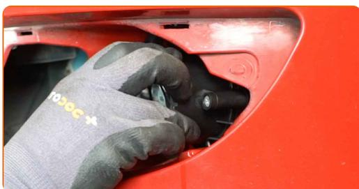
11 Enrosque las sujeciones del faro antiniebla. Utilice Torx T20.
