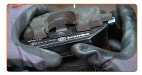
Instale la pinza de freno y fíjela. Use Vaso HEX No. H7. Utilice una llave de trinquete.
