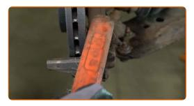
Retire las pastillas de freno. Use una palanca.
