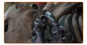
Desenrosque las sujeciones de la pinza de freno. Use Vaso HEX No. H7. Utilice una llave de trinquete.
