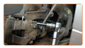
Instale las tapas de los fuelles guía de la pinza de freno.
