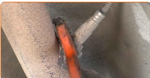
**7** Desenrosque la sujeción del sensor de oxígeno. Utilice un vaso para sensor de oxígeno de 22 mm. Utilice una llave de trinquete.
