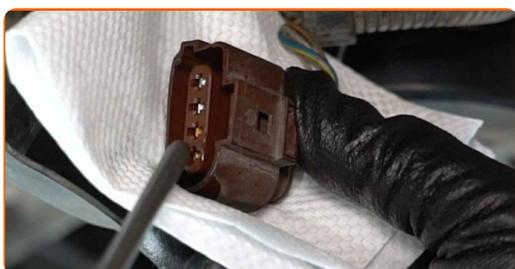
**14** Una el conector del sensor de oxígeno.
