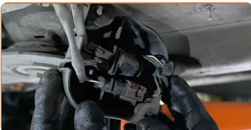
**4** Separe el conector del sensor de oxígeno.
