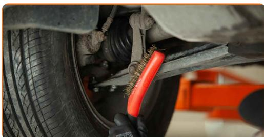
**3** Desenrosque las sujeciones que unen la bieleta a la barra estabilizadora y al brazo de control de la suspensión. Usa una llave mixta del n.º 16. Utilice una llave dinamométrica.
