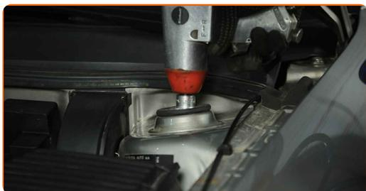
**38** Trate la sujeción superior del soporte del puntal de suspensión. Use grasa de cobre.
