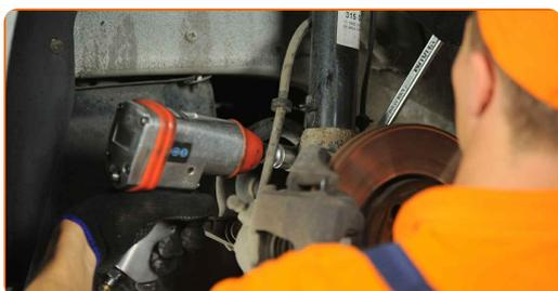
**13** Retire el perno de sujeción.
