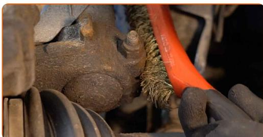
**12** Desatornille la sujeción inferior que conecta el puntal amortiguador a la mangueta de dirección. Usa una llave mixta del n.º 18. Use un vaso de impacto del n.º 18. Utilice una llave de trinquete.
