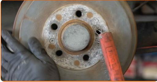
**36** Trate la superficie en la cual la llanta de la rueda entra en contacto con el tambor del freno. Use grasa de cobre.
