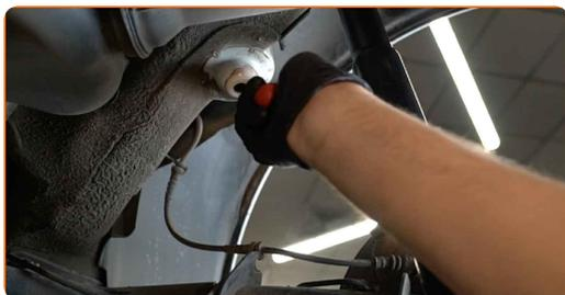
**19** Instale el espaciador de caucho en el nuevo muelle helicoidal.
