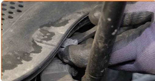
5 Desplace la rejilla del capó a un lado para acceder a las sujeciones del soporte del puntal de suspensión.
