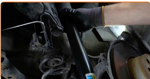
**33** Instale el perno de sujeción.
