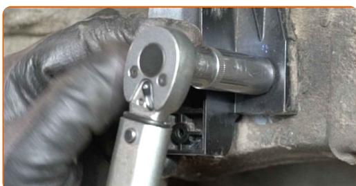
**40** Trate la sujeción del contenedor de carbón activo. Use grasa de cobre.
