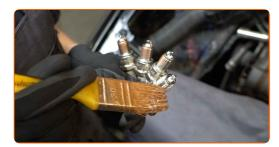
Instale las nuevas bujías en sus asientos de montaje. Use el vaso de bujía # 21.
