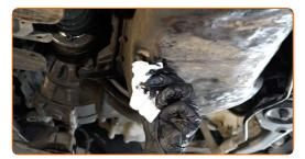
Atornille en el nuevo tapón de drenaje y apriételo. Use un vaso de impacto del n.º 19. Utilice una llave dinamométrica. Apriételo a un par de 28 Nm.
