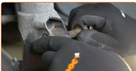
**12** Desconecte el muñón de dirección de la pata amortiguadora.
