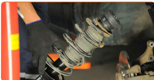
**18** Instale la pata amortiguadora en el mecanismo para apretar los resortes.
