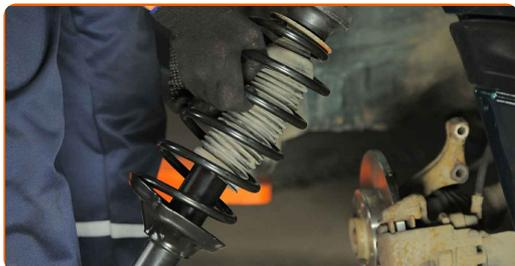
**34** Atornillen la fijación superior de la cazoleta de la pata amortiguadora.
