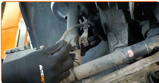
**9** Limpie las sujeciones que conectan el puntal amortiguador a la mangueta de dirección. Use un cepillo de alambre. Use el aerosol WD-40.
