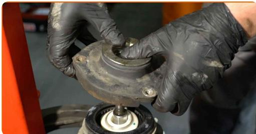
Sustitución: copelas del amortiguador - SEAT Toledo I Hatchback (1L).
