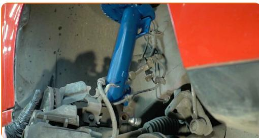
**49** Instale el perno de sujeción.
