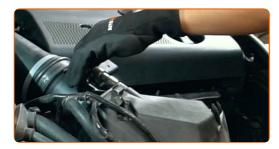
Atornille la abrazadera de sujeción que conecta el conducto de aire a la carcasa del filtro de aire. Use un vaso de impacto del n.º 7. Utilice una llave de trinquete.
