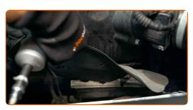
6 Separe el conector del sensor de flujo de masa de aire.
