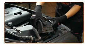
Desenrosque las sujeciones del escudo térmico de la carcasa del filtro de aire. Utilice un destornillador Phillips.
