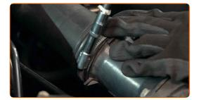
Desenrosque las sujeciones del sensor MAF. Use un vaso de impacto del n.º 10. Utilice una llave de trinquete.
