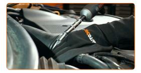
Trate el conector del sensor de flujo de masa de aire. Utilice grasa dieléctrica.
