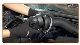
Apriete las sujeciones del sensor MAF. Use un vaso de impacto del n.º 10. Utilice una llave dinamométrica. Apriételo a un par de 4 Nm.
