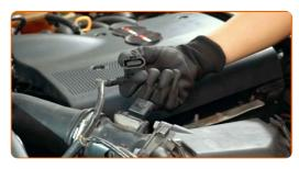
Afloje la abrazadera de sujeción que conecta el conducto de aire a la carcasa del filtro de aire. Use un vaso de impacto del n.º 7. Utilice una llave de trinquete.
