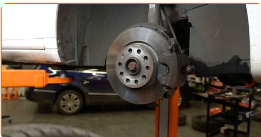
**7** Limpie el área donde se encuentra conectado el latiguillo de freno a la pinza de freno y a la tubería del circuito del freno. Use un cepillo de alambre. Use un limpiador de frenos.
