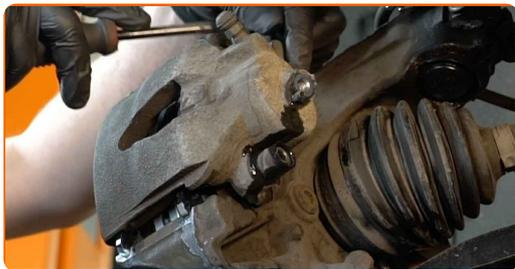
**13** Destornille la fijación del cáliper de freno. Use Vaso HEX No. H7. Utilice una llave de trinquete.
