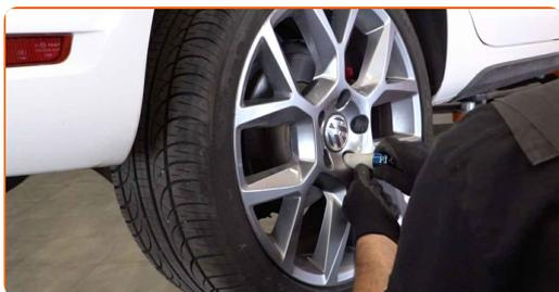
**28** Baje el automóvil y, manteniendo el orden cruzado, apriete los pernos de fijación de las ruedas. Utilice una llave dinamométrica. Apriételo a un par de 120 Nm.
