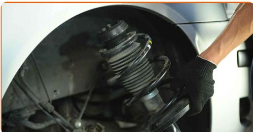
**36** Atornillen la fijación superior de la cazoleta de la pata amortiguadora.
