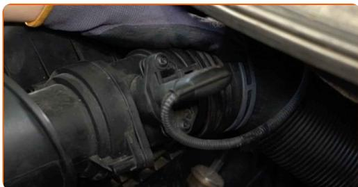
**14** Asegure la manguera de toma de aire con una abrazadera. Utilice un destornillador Phillips.
