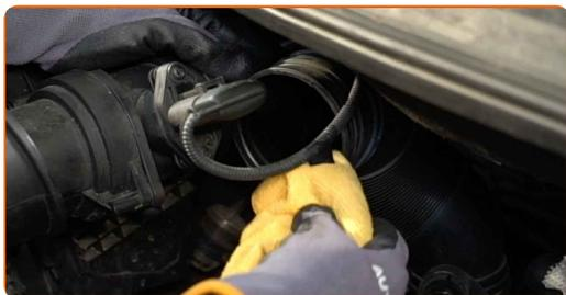
**13** Conecte el tubo de entrada de aire a la carcasa del filtro de aire.
