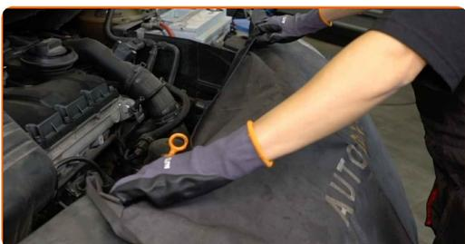
**3** Afloje los tornillos de sujeción de la cubierta del filtro de aire. Utilice un destornillador Phillips.
