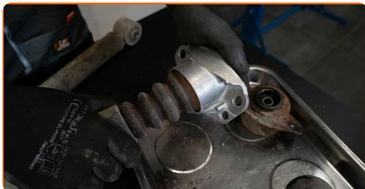
**17** Instale el nuevo soporte del amortiguador.
