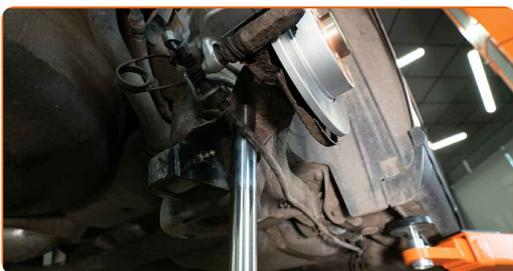
**8** Destornille la fijación inferior del amortizador. Use una llave mixta del n.º 16. Use un vaso de impacto del n.º 16.
