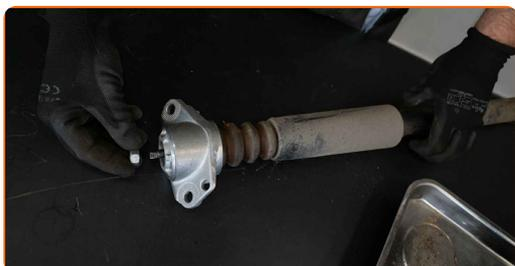
**18** Atornille la fijación de la cazoleta del amortiguador. Usa una llave mixta del n.º 16. Use una llave ajustable. Utilice una llave dinamométrica. Apriételo a un par de 25 Nm.
