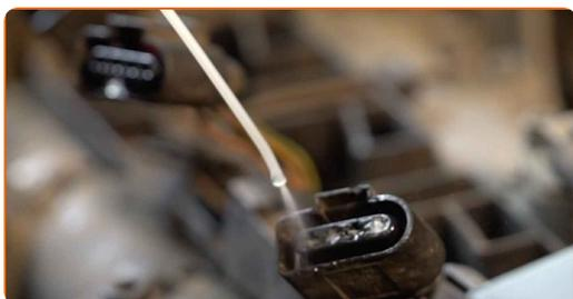
**16** Conecte los conectores de las bobinas del encendido.
