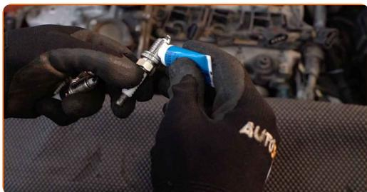
**13** Instale las nuevas bujías en sus asientos de montaje.
