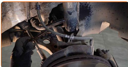
**16** Suelte la sujeción inferior que conecta el puntal amortiguador a la mangueta de dirección. Utilice un vaso de impacto especial para extraer el amortiguador. Utilice una llave de trinquete.
