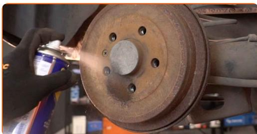
**7** Destornille la fijación del tambor de freno. Utilice un destornillador Phillips.
