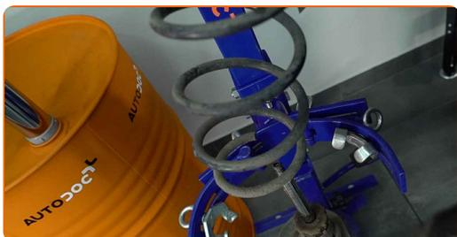
35 Retire el amortiguador viejo del compresor de muelles hidráulico.
