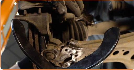
21 Desenrosque la fijación que conecta el eje de transmisión al cubo de la rueda. Utilice un vaso de 12 puntos # 36.
