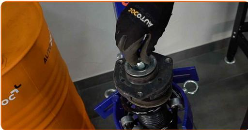
41 Apriete la tuerca de la varilla de la pata amortiguadora. Usa una llave mixta del n.º 21. Use Vaso HEX No. H7. Utilice una llave dinamométrica. Apriételo a un par de 60 Nm.
