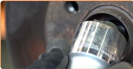
22 Trate el asiento de montaje del eje de transmisión en la mangueta de dirección. Use el aerosol WD-40.
