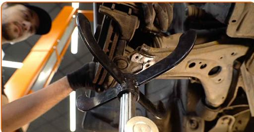
20 Desconecte la bisagra esférica del brazo. Use una palanca.
