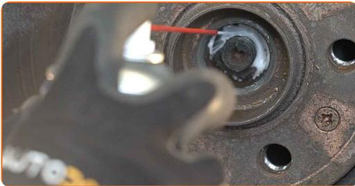
23 Del muñón de dirección saque el árbol propulsor y, al levantarlo, átelolo a la carrocería. Use un punzón. Utilice un martillo.
