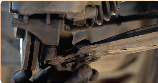
55 Apriete la fijación del soporte esférico. Use un vaso de impacto del n.º 13. Utilice una llave dinamométrica. Apriételo a un par de 20 Nm.+90°
