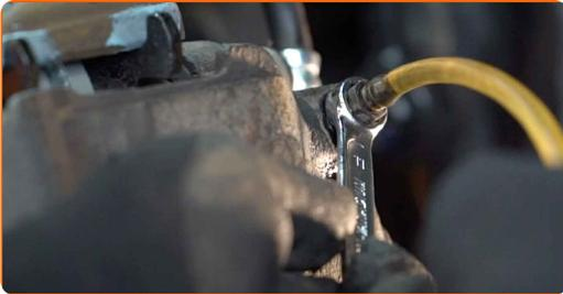
23 Desconecte la manguera del kit de purgado de frenos.
