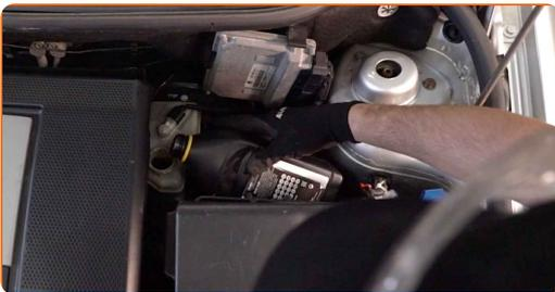
32 Apriete el tapón del depósito de líquido del freno. Cierre la capota.
