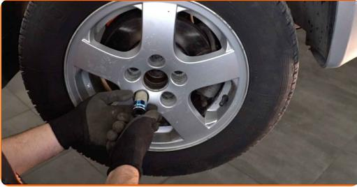
29 Baje el automóvil y, manteniendo el orden cruzado, apriete los pernos de fijación de las ruedas. Utilice una llave dinamométrica. Apriételo a un par de 120 Nm.
