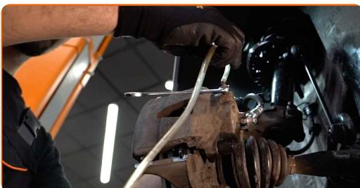
21 Presione varias veces el pedal de freno para retirar aire del sistema.
