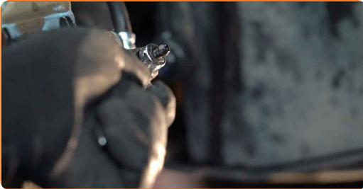
24 Limpie la suciedad del perno del latiguillo de freno. Use un limpiador de frenos.
