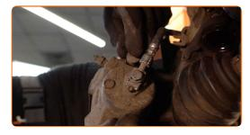
Limpie la superficie de la pinza del freno. Use un cepillo de alambre. Trate la superficie donde el disco del freno entra en contacto con la llanta de la rueda. Use grasa de cobre.
