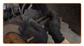
Trate el pistón de la pinza de freno. Use el aerosol WD-40.
