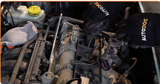
Sustitución: bobina de encendido - SKODA Fabia I Hatchback (6Y2). Consejo:
