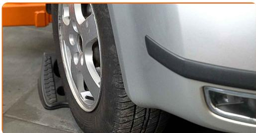
**2** Afloje los pernos de fijación de la rueda. Utilice una llave de impacto para llanta # 17.
