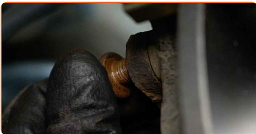
**29** Apriete las sujeciones del soporte de la pinza de freno. Use Vaso HEX No. H8. Utilice una llave dinamométrica. Apriételo a un par de 65 Nm.
