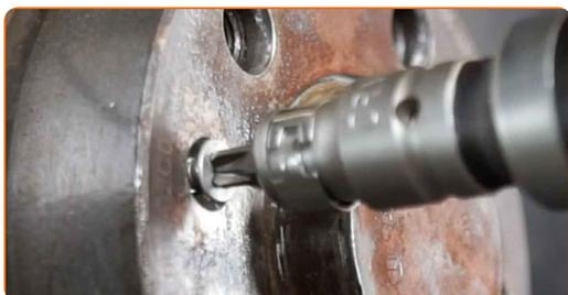
**19** Retire el perno de sujeción.
