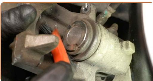
**31** Presione el pistón de la pinza de freno. Utilice la herramienta de retorno del pistón de freno.
