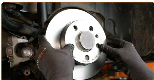
**24** Instale el perno de sujeción.
