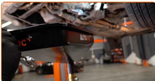
**10** Destornille el tapón de desagüe. Use un vaso de impacto del n.º 17. Utilice una llave de trinquete.
