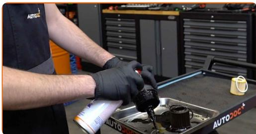
**20** Instale una nueva junta tórica en el asiento de montaje de la cubierta del filtro.
