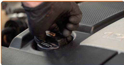
**37** Pongan en marcha el motor por unos minutos. Después de que se apague la luz de advertencia de presión del aceite, detenga el motor.
