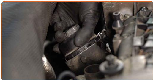
**30** Atornille la tapa. Use un vaso de impacto del n.º 36. Utilice una llave dinamométrica. Apriételo a un par de 25 Nm.
