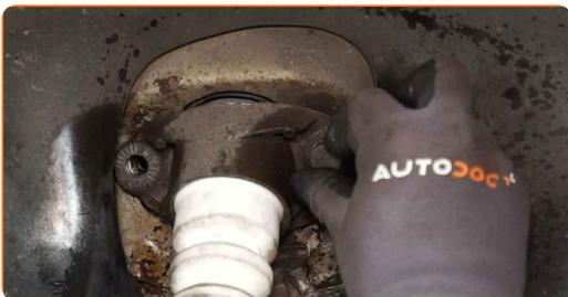
**27** Enrosque las sujeciones del soporte del amortiguador. Use un vaso de impacto del n.º 16. Utilice una llave de trinquete.
