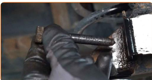
**10** Limpie las fijaciones del soporte de montaje superior del amortiguador. Use un cepillo de alambre. Use el aerosol WD-40.
