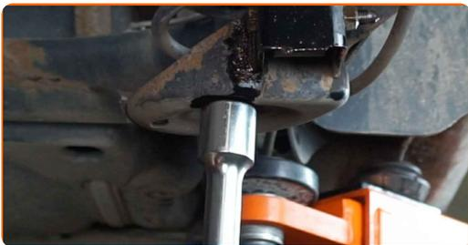
**8** Desenrosque las sujeciones inferiores del amortiguador. Usa una llave mixta del n.º 16. Use un vaso de impacto del n.º 16. Utilice una llave de trinquete.
