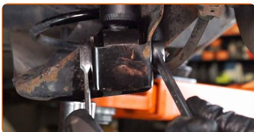
**30** Para apretar las sujeciones correctamente, debe elevar con un gato los componentes de la suspensión hasta su posición de trabajo. Utilice un gato de transmisión hidráulica.
