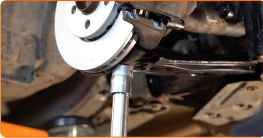
26 Apriete la sujeción delantera que conecta el brazo de control al subchasis. Use un vaso de impacto del n.º 18. Utilice una llave dinamométrica. Apriételo a un par de 70 Nm.+90°
