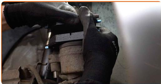
**22** Establezcan el soporte de freno y lo fijen. Use Vaso HEX No. H7. Utilice una llave dinamométrica. Apriételo a un par de 30 Nm.
