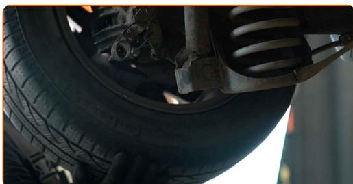
**7** Desconecten el punto de separación eléctrico del sensor ABS. Desconecte la clavija del sensor de desgaste de las pastillas de freno. Retire el conector del sensor de ABS. Retire el conector del sensor de desgaste de la pastilla de freno.
