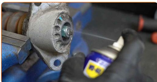
**18** Destornille la fijación de la varilla del amortiguador. Utilice un vaso para amortiguador DDN#6. Use un vaso de impacto del n.º 16. Utilice una llave de trinquete.
