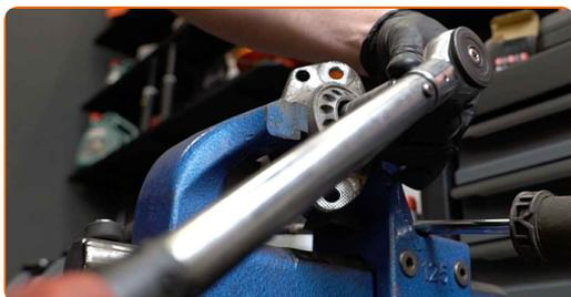
**22** Trate la sujeción de la varilla del amortiguador. Use grasa de cobre.
