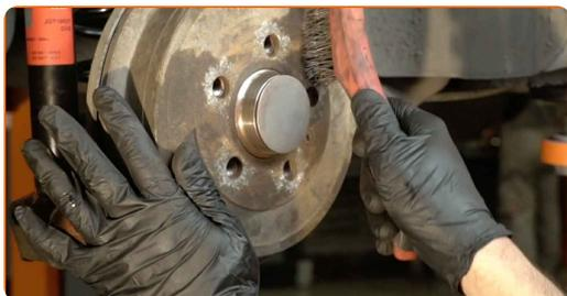
**23** Trate la superficie en la cual la llanta de la rueda entra en contacto con el tambor del freno. Use grasa de cobre.
