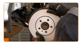
Apriete la fijación del disco de freno. Utilice una llave dinamométrica. Apriételo a un par de 4 Nm.
