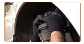
Establezcan el soporte de freno y lo fijen. Use Vaso HEX No. H7. Utilice una llave dinamométrica. Apriételo a un par de 30 Nm.
