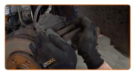
Destornille la fijación del disco de freno. Utilice un destornillador Phillips. Utilice una llave de trinquete.
