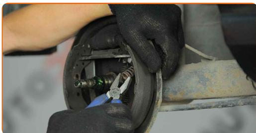
**13** Afloje la sujeción de las dos zapatas de freno junto con el mecanismo de ajuste del cilindro secundario de freno, sin hacer el daño a los guardapolvos.
