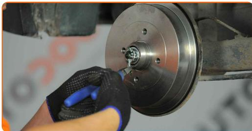
**9** Destornille la fijación del cubo de la rueda. Usa una llave mixta del n.º 24.
