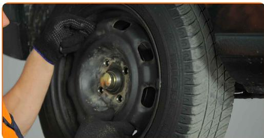
**7** Saque el casquete protector del cojinete del cubo. Utilice un cincel de metal plano. Utilice un martillo. Utilice un destornillador plano.
