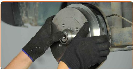
**26** Atornille el elemento de sujeción del cubo de rueda. Usa una llave mixta del n.º 24.
