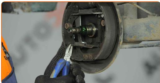
**12** Retire los clips de retención de las pastillas de freno. Utilice alicates.
