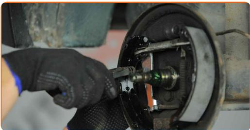
**24** Instale el resorte de retención de las pastillas de freno. Utilice alicates.
