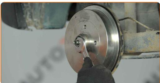
**27** Instale la chaveta de la tuerca de fijación del cojinete del cubo. Utilice un martillo. Utilice tenazas.
