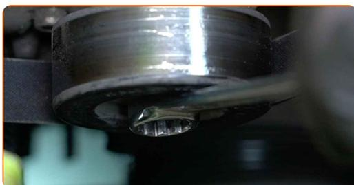
**7** Coloque la correa acanalada en V en la polea tensora.
